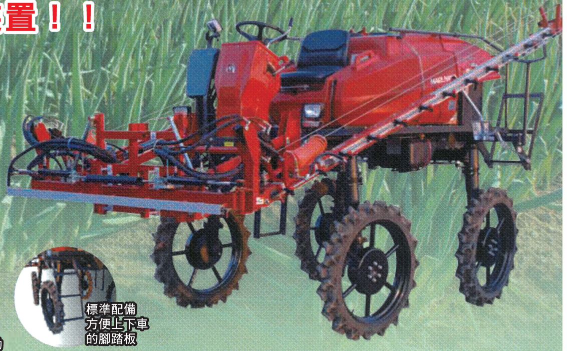
由3組擺動緩衝器抑制噴桿搖動
